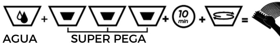
*\*Se puede mezclar con palustra o con un taladro mezclador a baja velocidad (300 rpm).<sup>2</sup> Si la mezcla se endurece, NO agregue más agua o producto. Realice una nueva mezcla.*
